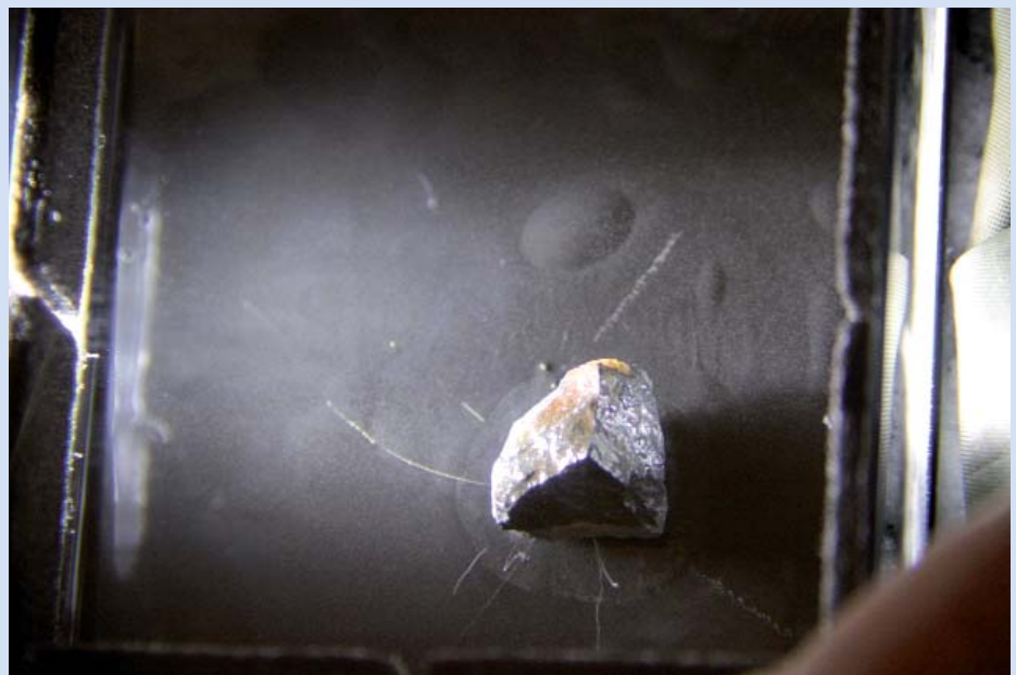
Abb. 6: Radiale Bahns Spuren, ausgehend von einem kleinen Stück Columbit
