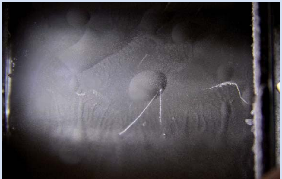
Abb. 4: V-förmige Bahnen des Radon-Zerfalls in der Hands-on-Nebelkammer
